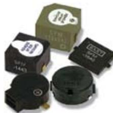
Зуммеры пьезоэлектрические серии SFM для поверхностного монтажа.
