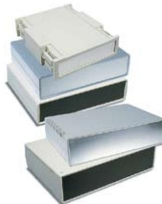
Приборные корпуса серии G7 изготавливаются из обычного или из неподдерживающего горения ударопрочного ABS пластика. Верхняя и нижняя часть текстурированы, что позволяет избежать царапин и поддерживает внешнюю отделку в хорошем состоянии. Внутри корпуса имеют направляющие пазы и отливки для вертикального и горизонтального крепления печатных плат
