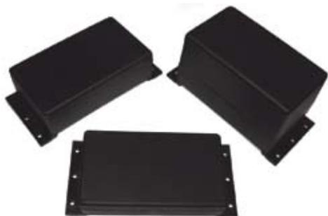
Пластмассовые корпуса G084...G089 из четырех частей, изготовленных из черного пластика. В нижней части предусмотрена возможность крепления платы внутри корпуса посредством шурупов. Имеются две прикручивающиеся накладки для крепления корпуса к стене. Все части соединяются шурупами.
